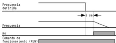
10.8 Definición de la operación con resistor de frenado
